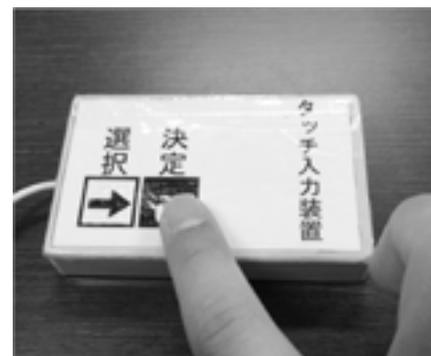
図7 開発したタッチ入力装置
