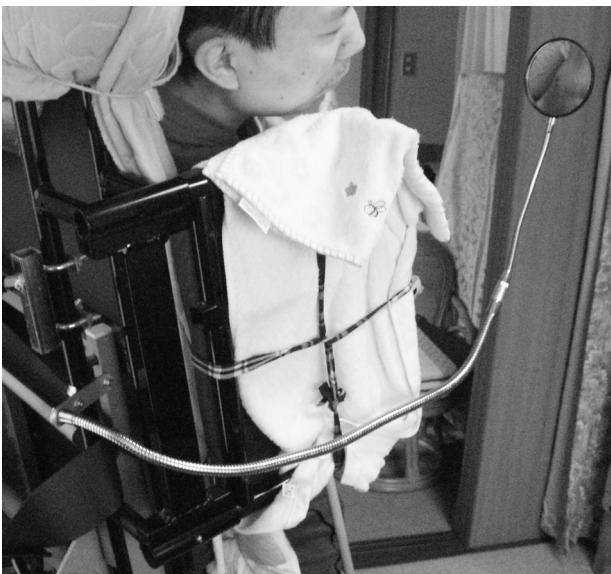
図9 作製したバックミラー Fig.9 Advanced rearview mirror
