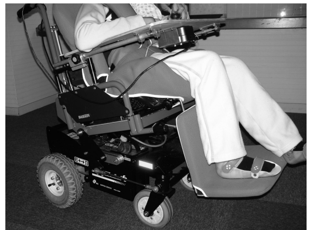
図4 改造した電動車いす（ティルトタイプ） Fig.4 Advanced electric wheelchair installed tilting mechanism
