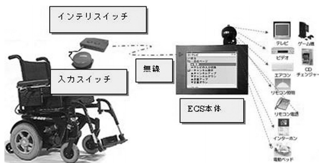
図6 入力スイッチのワイヤレス化 Fig.6 Wireless input switch in ECS
