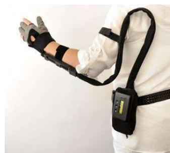
指の先端の圧力センサーで、あなたが握ろうとする動作と同時にモーターが駆動して「にぎる」力をサポートします。強く力を入れれば強いパワーが、弱く力を入れれば弱いパワーが作動します。
